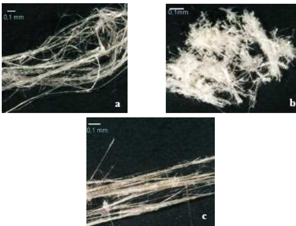
Zdjęcie 2 Długowłóknisty azbest chryzotylowy praktycznie nie zawierający talku(a), chryzotylowy azbest krótkowłóknisty zanieczyszczony talkiem (b) i azbest amozytowy (c)
