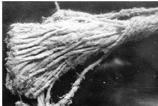
Zdjęcie 7 Sznur azbestowy stosowany w uszczelnieniach izolacji cieplnej
